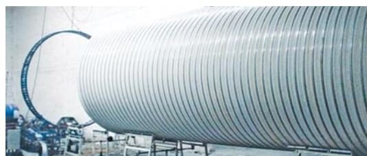
Máquina con aro fijo: mediante este sistema es posible fabricar toda la gama de diámetros con variaciones de más menos 5cm.
