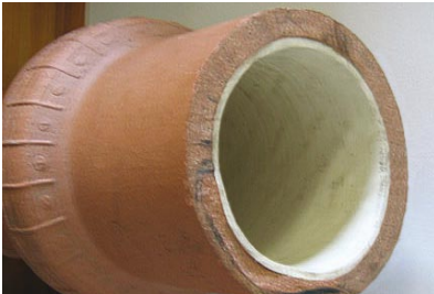
Tubo de albañal rehabilitado
